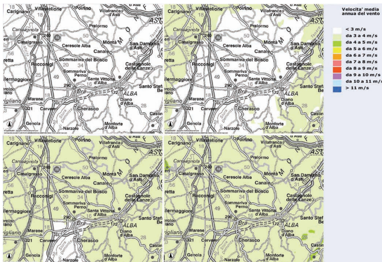
Figura 6. Mappe di velocità media annuale del vento a diverse altezze dal suolo (da in alto a sx in senso orario a 25 m, 50 m, 75 m e 100 m dal suolo); fonte: Atlante Eolico Italiano, ERSE.
